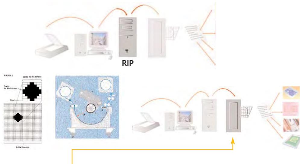
En la filmadora un **rayo de luz láser** hace un barrido horizontal sobre la película sensible, **exponiendo o no exponiendo foto-elementos** (recorder elements o rels) ubicados en posiciones con **coordenadas fijas sobre la retícula de la filmadora** (recorder grid).
